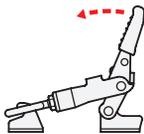
Hebelarm anheben, bis der Zuganker im Gegenhalter außer Eingriff ist.
