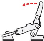
Zum **Spannen** den Hebelarm anheben, bis der Zuganker am Gegenhalter aufliegt.
