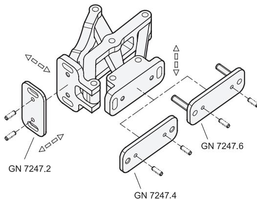
Die Mehrgelenkscharniere lassen sich bei der Montage in drei Ebenen justieren. So können z.B. Toleranzen ausgeglichen oder benötigte Anpressdrücke für Dichtungen eingestellt werden. Zwei Ebenen können über die parallel bzw. senkrecht angeordneten Langlöcher in den Befestigungsflanschen justiert werden. In der dritten Ebene lassen sich durch die Verwendung der Distanzplatten GN 7247.2 entsprechend Positionskorrekturen vornehmen.
