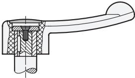
Schaltgriff GN 623 / GN 623.5 befestigt mit Nabennut / Passfeder unter Verwendung von Vorlegescheiben GN 184 / GN 184.5
