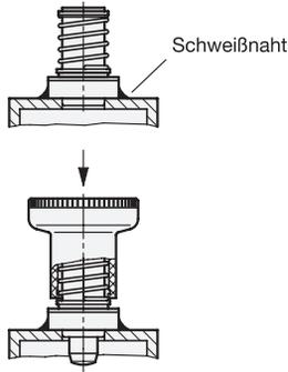
Um den Kunststoffknopf nicht zu beschädigen, wird dieser erst nach dem Schweißvorgang mit einem Schonhammer aufgeschlagen.
