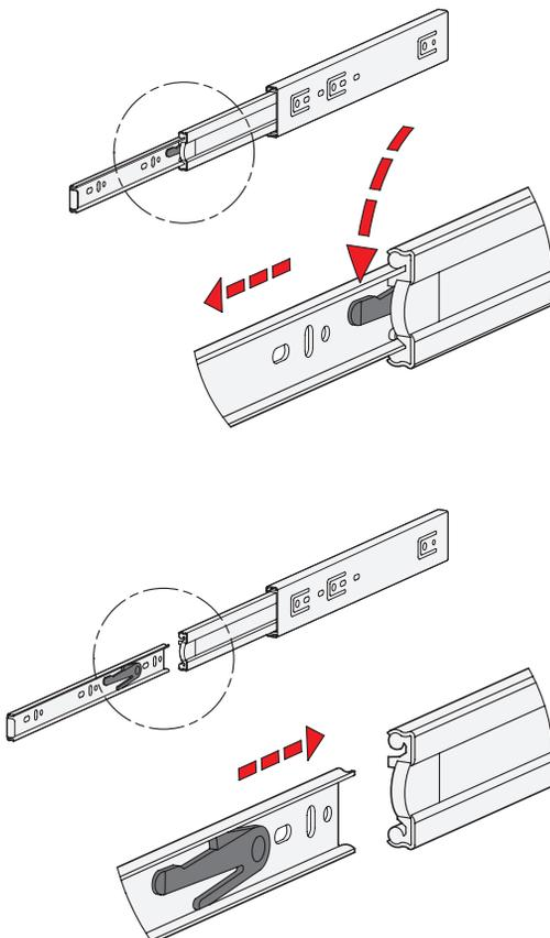
Die Form F verfügt zusätzlich über eine Trennfunktion, durch welche sich der Auszug im Bereich der Mittel- und Innenschiene komplett voneinander trennen lässt. Dies erleichtert zum einen die Montage, zum anderen kann der Auszug z. B. bei häufigen Wartungsarbeiten an dahinter liegenden Bauteilen schnell entnommen werden.
