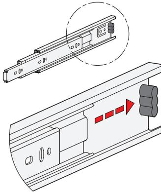
Die Stoppgummi der Form F dämpfen das Anschlagen der Schiene in der jeweiligen Endstellung. Dadurch wird die Geräusentwicklung minimiert und die Lebensdauer erhöht. Teils versteckt, teils sichtbar an den Schienen angebracht sind sie bzgl. Gestalt, Werkstoff und Härte auf die jeweiligen Anforderungen abgestimmt.
