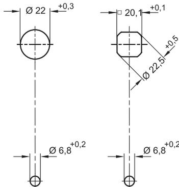
Zur Montage wird die Tür bzw. Klappe oder Luke mit zwei Bohrungen gemäß einer der beiden Skizzen versehen.
